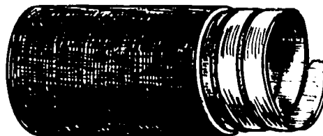
Liquid-tight flexible-metal conduit
